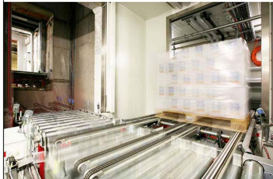
Hubtische überwinden die Niveaudifferenzen zwischen den einzelnen Lagerbereichen, hier in der Passage zwischen Neu- und Bestandsbau (rechts).
